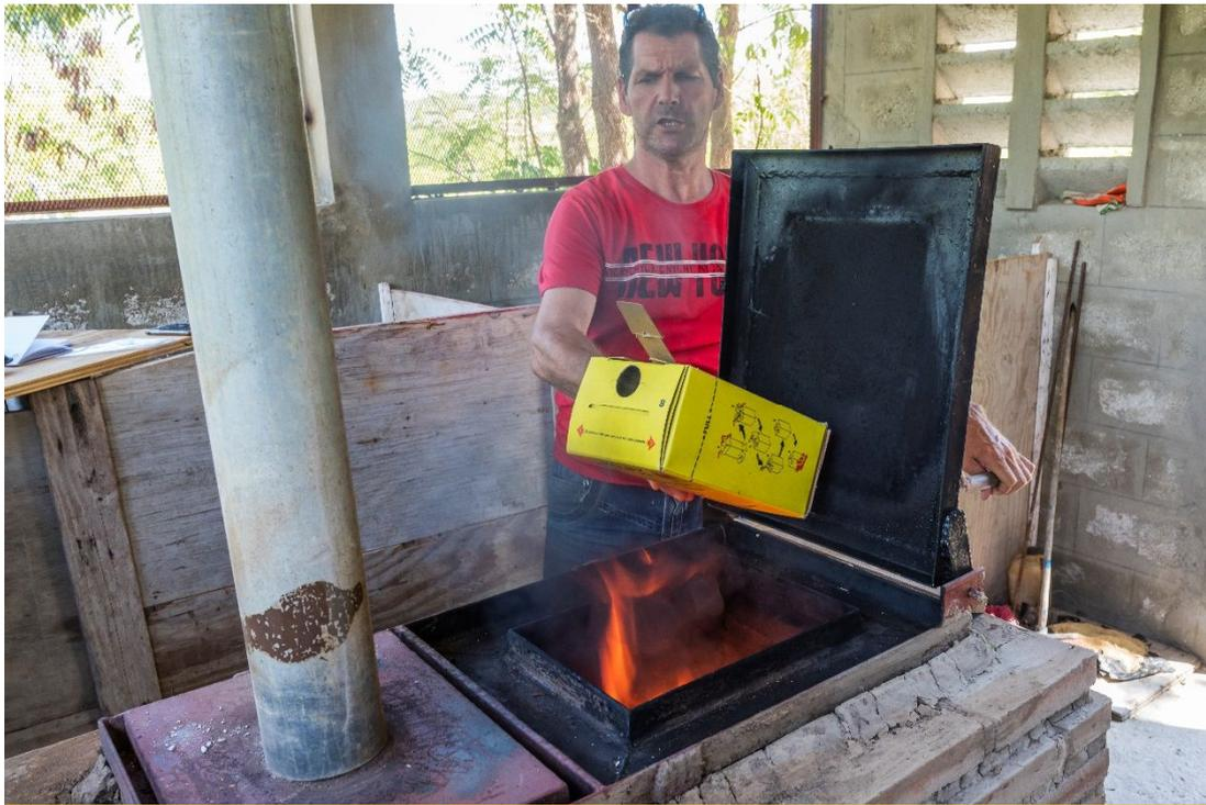
Norbert Morel wirft eine Sicherheitsbox mit Medizinalabfällen wie Spritzen, Nadeln usw. in die Brennkammer «seines» selbstgebauten Verbrennungsofens in Valheureux. Die Abfälle werden unter hohen Temperaturen verbrannt und so fachgerecht entsorgt.
